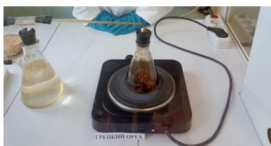
Рисунок 5. Пиролиз растительных отходов
