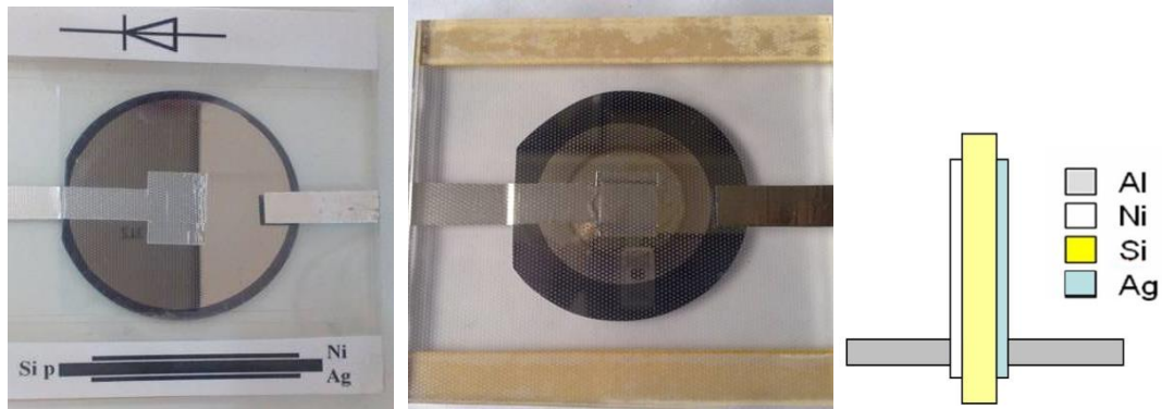
Рис. 3 а, б) изготовленный диод Шоттки (вид со стороны омического контакта и выпрямляющего контакта) ; в) структура Ni, Si-p, Ag
