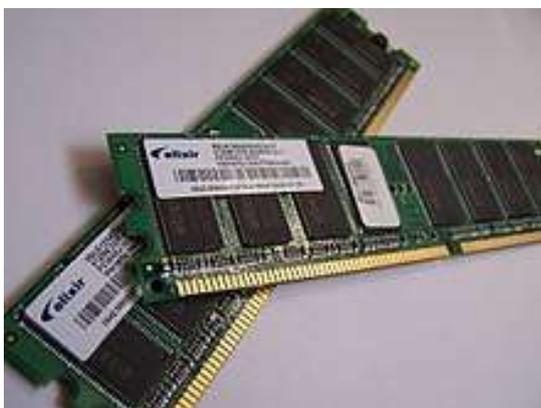
Рис.3. Модули ОЗУ для ПК
