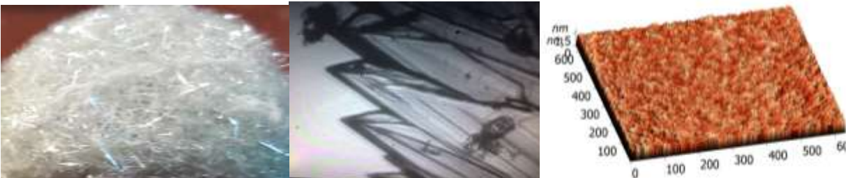
Рис. 17 а – Катализатор (оксид молибдена \text{MoO}_3 ); б -увеличение в 400 раз; в – изображение на атомно-силовом микроскопе (ЦКП СОГУ)
