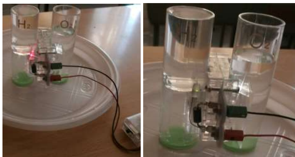
Рис. 13– Электролиз дистиллированной воды. Накопление водорода и кислорода для работы в режиме топливного элемента
