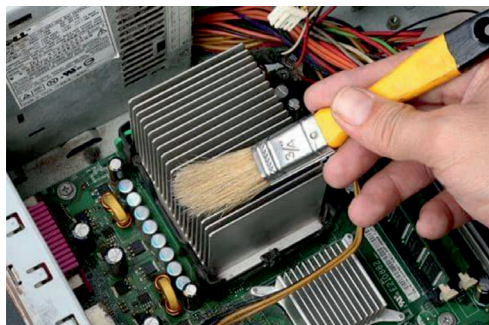
Рис. 13. Удаление пыли с аппаратной части компьютера
