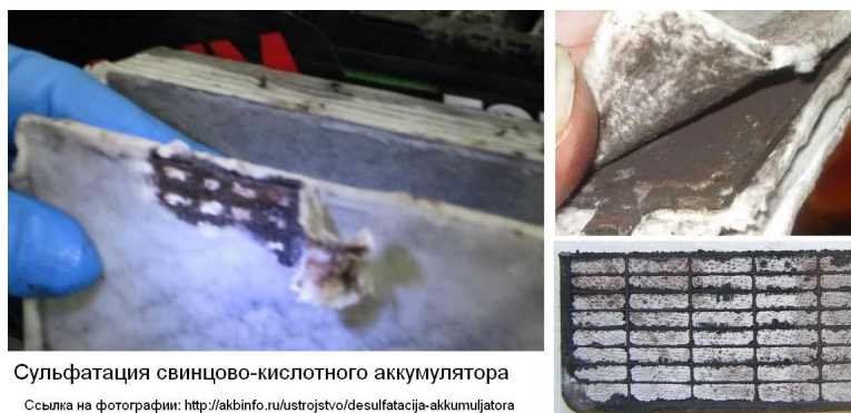
Рис. 1. Сульфатированные пластины аккумулятора
