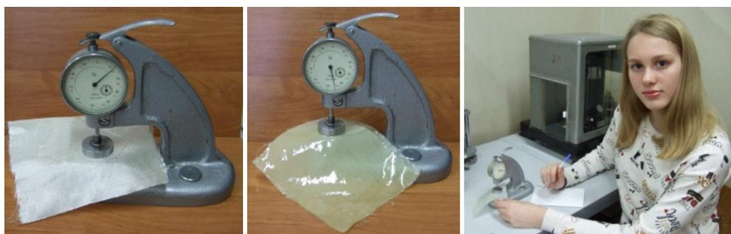
Рис. 9. Измерение толщины образцов на микрометре
