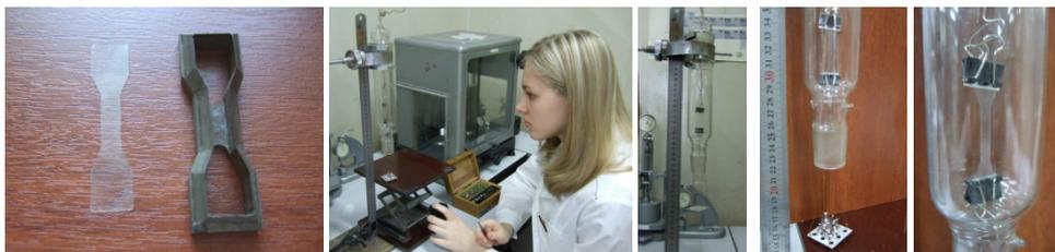
Рис. 13. Измерение прочности образцов на разрыв
