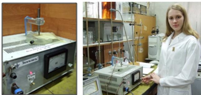
Рис. 10. Измерение электрической прочности образцов
