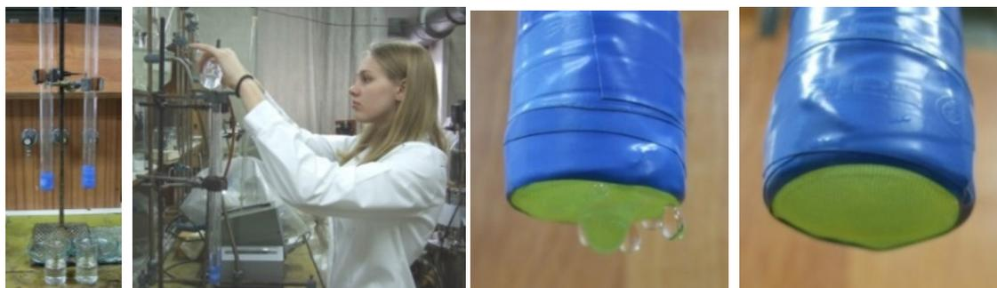
Рис. 18. Проверка тканей на водонепроницаемость
