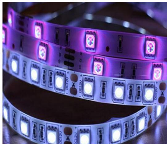
Рис. 3. Адресная светодиодная лента
