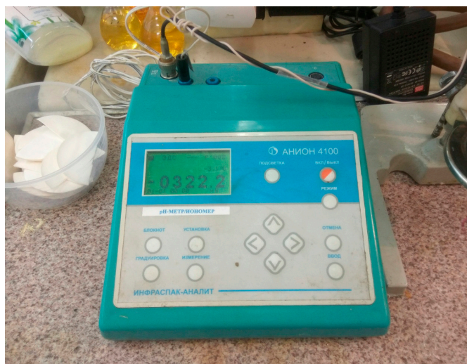
Рис. 3. pH-метр/иономер «Анион 4100», состоящий из фторид-селективного электрода «ЭЛИТ-221» и вспомогательного хлорид-серебряного электрода «ЭВЛ-1М3»
