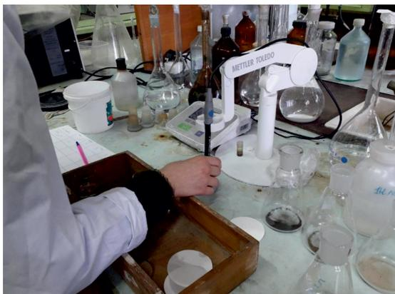
*Определение кислотности талой воды.
