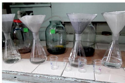
Фильтрация проб талой воды
