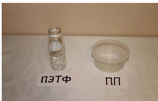
Рис. 1. Изделия из полимеров ПЭТФ и ПП, образцы из которых исследовались в работе
