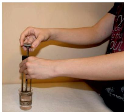
Рис. 3. Растяжение образца полимера в жидкой среде
