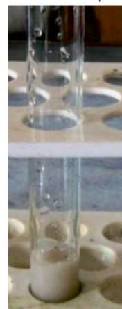
К 10 мл пробы раствора глины прибавили 3 капли соляной кислоты и прилили 0,5 мл раствора хлорида бария. При концентрации сульфат – ионов более 100 мг/л выпадает осадок:
