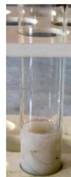
К 10 мл пробы раствора глины прибавили 4 капли азотной кислоты и прилили 0,5 мл раствора нитрата серебра. Белый осадок выпадает при концентрации хлорид – ионов более 100 мг/л:
