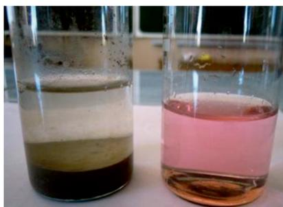
Последним этапом работы было качественное определение ионов, входящих в состав глин. Для перевода анализируемых ионов в раствор образец глины заливали раствором  $H_2SO_4$ . Обнаружение ионов в полученном растворе проводили дробным методом с помощью специфических реакций.
