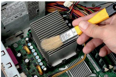
Рис. 13. Удаление пыли с аппаратной части компьютера
