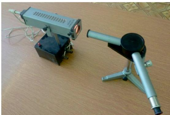
*Рис. 4. Оборудование для наблюдения спектра излучения в области видимого света лампы накаливания*
