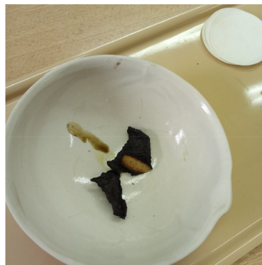
Остаток после горения образца № 1
