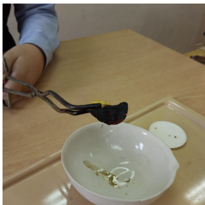
Остаток после горения образца № 2
