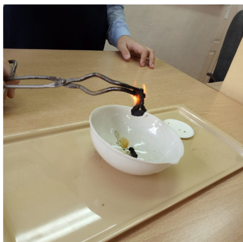
Остаток после горения образца № 3
