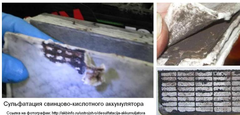
Сульфатация свинцово-кислотного аккумулятора
