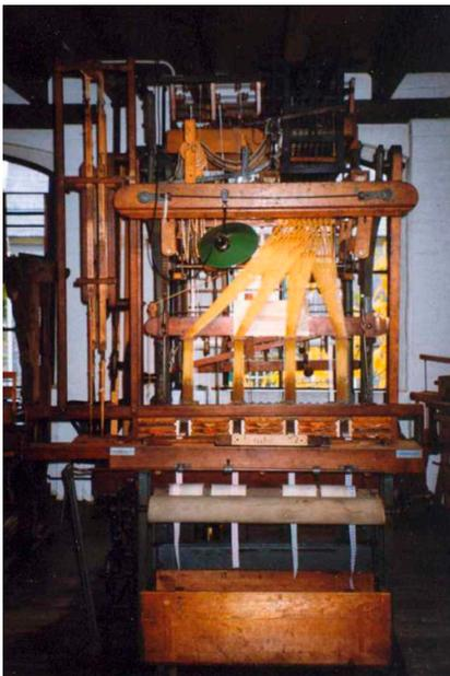
Рис. 4. Жаккардовый ткацкий станок
