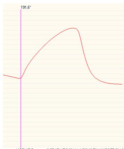
Рис. 2. Термограмма кристаллизации расчётного состава 0,6LiF-55,9LiNO<sub>3</sub>-43,5NaNO<sub>3</sub> (мол.%)
