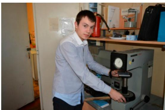
*Измерение твёрдости по Бринеллю*
