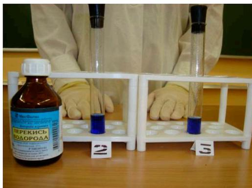
Рис. 1. Влияние кислорода на взаимодействие меди с раствором аммиака и полученные растворы:
