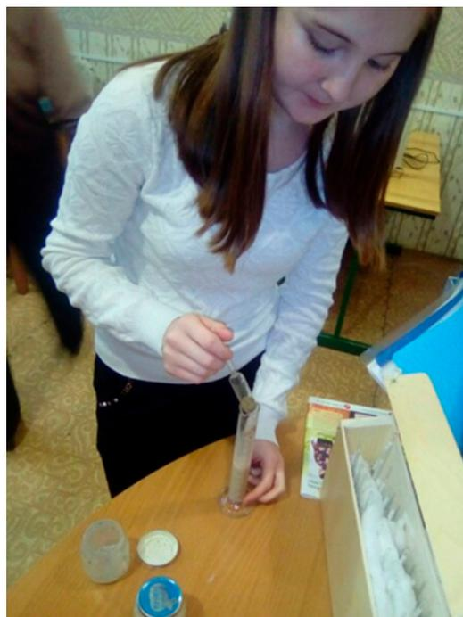
Фото 9. Измерение плотности растворов
