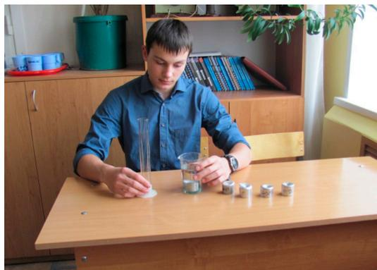
*Измерение объёма образцов*
