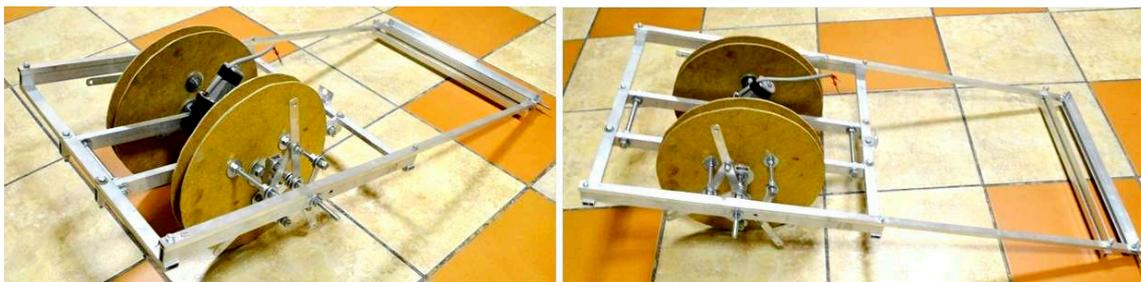
Рис. 9. Общий вид действующего макета с шагающим колесом
