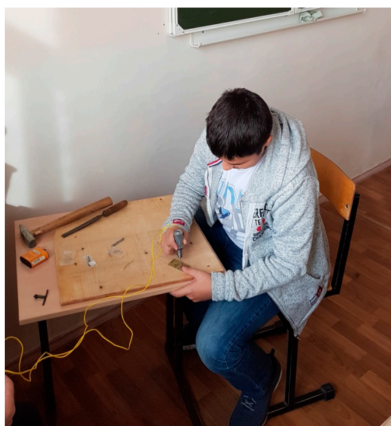
Фото 2. Автор сверлит отверстия в текстолите
