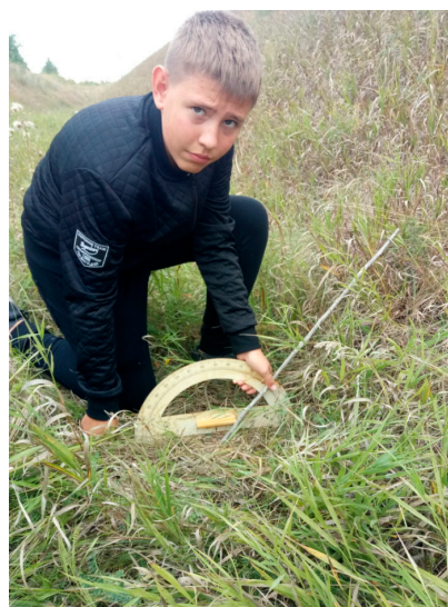
Рис. 2. Определение крутизны склона
