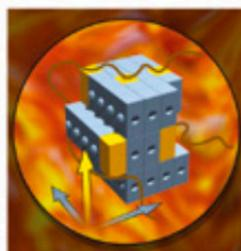
Сближение кристаллов парафина предотвращается, структуры получаются мельше и хаотичнее
