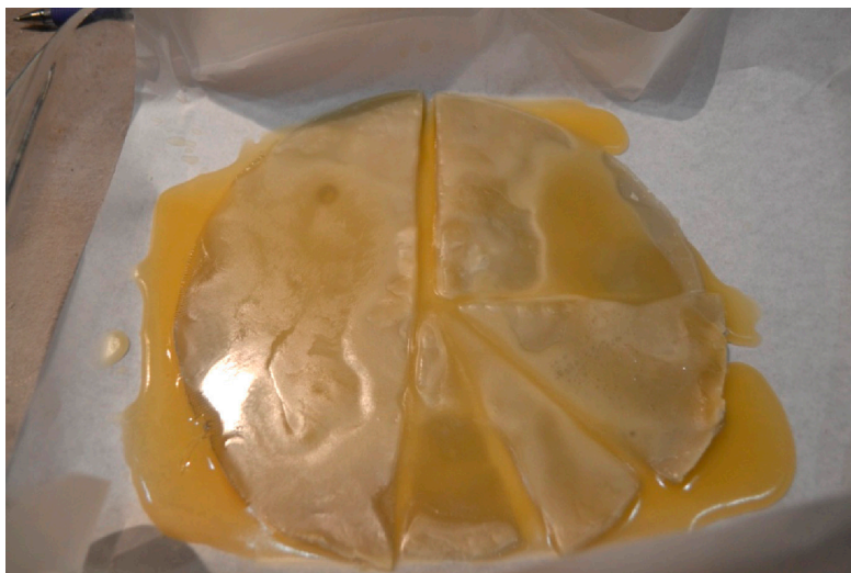
Поврежденную таким образом сетку залили более толстым слоем воска и получили образец композитного материала для испытаний
