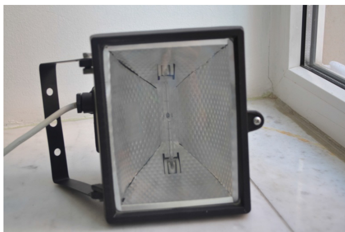
Прожектор, используемый для бесконтактного и достаточно равномерного нагрева образца композитного материала
