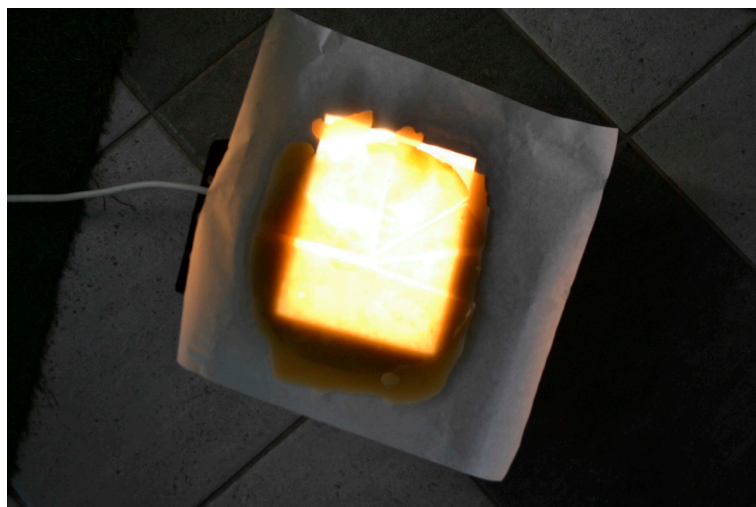
Металлическо-восковой композит во время нагрева прожектором
