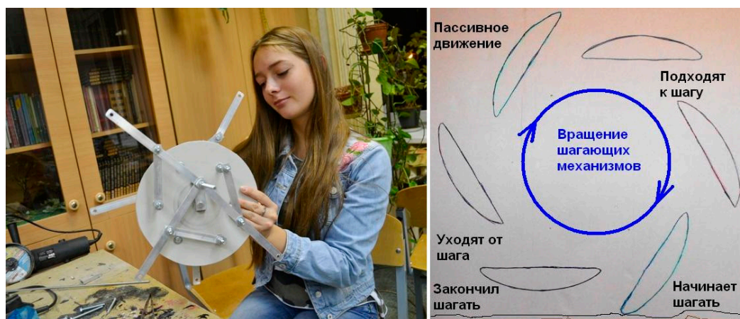
Рис. 1. Схема работы шагающего колеса
