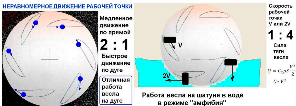
Рис. 6. Схема движения шагающего колеса в воде
