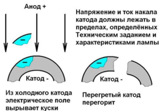
Рис. 4. Схема разрушения недогретого или перегретого катода лампы
