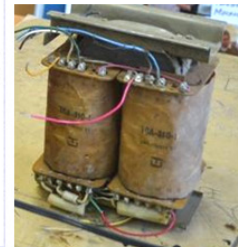
Рис. 2. Моточные данные и вид трансформатора ТСА-310-2 [3]
