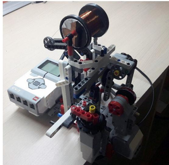
*Рис. 1. Намоточный станок*
