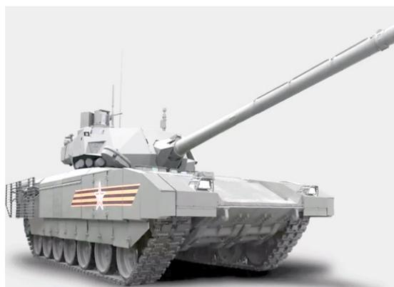
Рис. 8. Танк Т-14 на тяжелой гусеничной основе «Армата»
