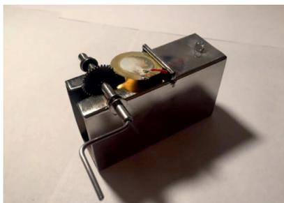
Установка вырабатывает электрический ток при вращении ручки. Получаемого напряжения достаточно для того, чтобы подключенный светодиод начал светиться. Вы можете наблюдать данный эффект на кадре из демонстрационного видео.
