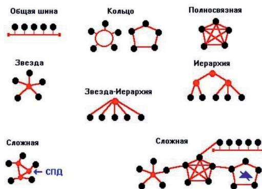
Рис. 2. Представление топологии компьютерных сетей в виде графов
