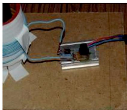
Подобрав нужные детали, я начал с намотки катушки. Наматывать следует на каркас **виток к витку без перехлестов** и заметных пробелов, примерно 1500 витков. После этого нужно обеспечить изоляцию и закрепить намотку, лучше всего для этого использовать лак, которым покрыть обмотку в несколько слоёв. Далее собираем схему. Первичная обмотка – 9 витков проводом 1,5 мм на каркасе 8 см. Питание – 12 В с током до 1 А.
