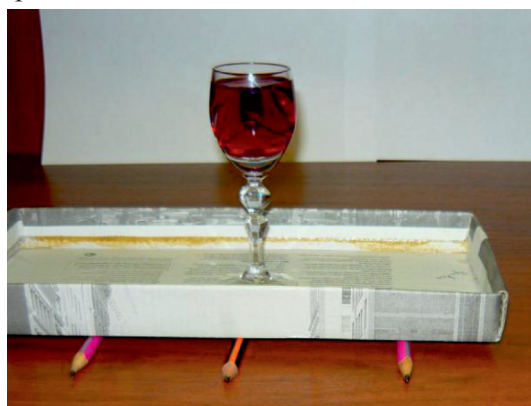
Фото 5. Экспериментальное исследование движения тел, перемещаемых с помощью катков-карандашей, имеющих в сечении треугольник Рёло
