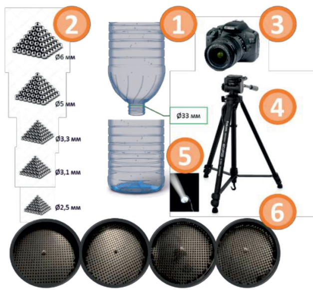
Рис. 3. Схема стенда «Песочные часы». Истечение шариков d = 2,5 \text{ мм}
