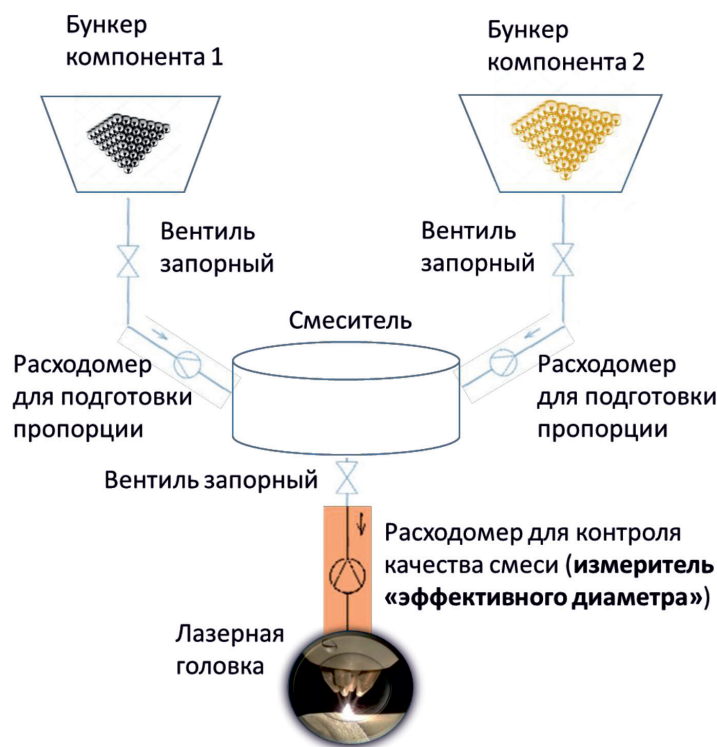
Рис. 10. Возможная схема системы контроля качества подаваемой на лазерную головку 3D принтера смеси с использованием расходомера-измерителя «эффективного диаметра смеси».
