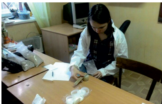
Рис. 3. Лабораторные исследования определение плотности сложения солоди
