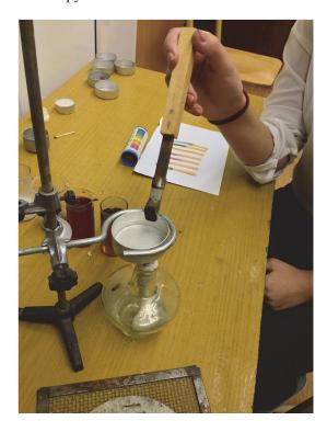
Опыт №4. В алюминиевой кастрюле проведено кипячение раствора соляной кислоты с концентрацией 0,01 моль/л в течении 15 мин. Затем остудила раствор и проверила его на наличие ионов алюминия раствором гидроксида натрия.
