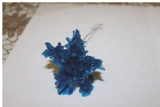
Этап 3: Накрыли сверху ёмкость с раствором салфеткой от попадания пыли и мусора. Выдержали раствор в течение 4 часов, вынимаем из него заготовку и видим первые кристаллики. Продолжаем выращивать кристалл.
