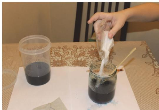
Этап 2: Насыщенный раствор оставили охлаждаться до комнатной температуры. Из фетра вырезали заготовку в виде звезды, закрепили металлическую проволоку в заготовке и подвесили заготовку в центр раствора.
