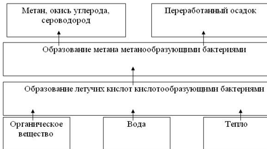
Рис. 2. Схема сбраживания органических веществ
