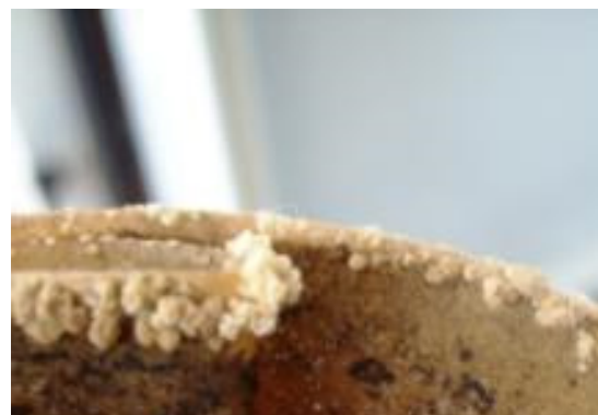
Формирование кристаллов соли при фильтровании исследуемого образца
