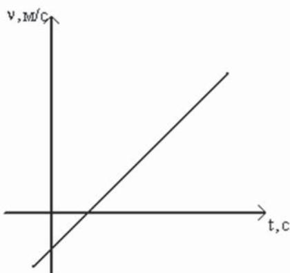
На графике представлена зависимость скорости тела от времени. Скорость отложена по оси абсцисс, измеряется в м/с, время по оси ординат, измеряется в секундах. Зависимость скорости от времени линейная. График имеет две особые точки – точки пересечения с осями координат. Точка пересечения с осью ординат показывает, какая скорость была у тела в начальный момент времени, точка пересечения с осью абсцисс
