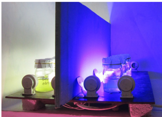
Рис. 4. Подсветка опытных емкостей с культурам микроводорослей: А – лампа ЛД-40 и SYLVANIA Coralstar; Б – лампа OSRAM FLUORA L18W/77
