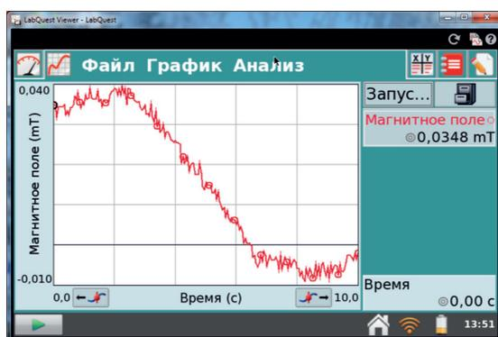
Рис. 6. Исследование индукции магнитного поля пылесоса LG V-C5A42ST
