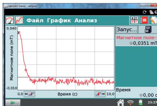
Рис. 2. Исследование индукции магнитного поля компьютера
