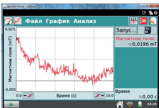
Рис. 5. Исследование индукции магнитного поля телевизора SAMSUNG UE40J5500AUXRU
