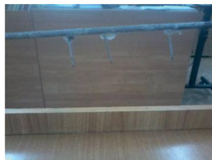
К краю стержня подносят свечу. Поскольку край стержня нагревается, то постепенно стержень прогревается. Когда тепло доходит до места крепления гвоздик со стержнем, стеарин плавится, и гвоздик падает. Мы видим, что в данном опыте нет переноса вещества, соответственно, наблюдается теплопроводность.
