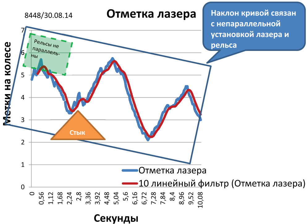
График поперечных колебаний колесной пары. Съемка 8448 30.08.2016
