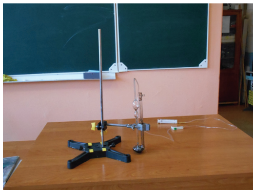
Рис. 8. Определение кинематической вязкости магнитной жидкости капиллярным методом
