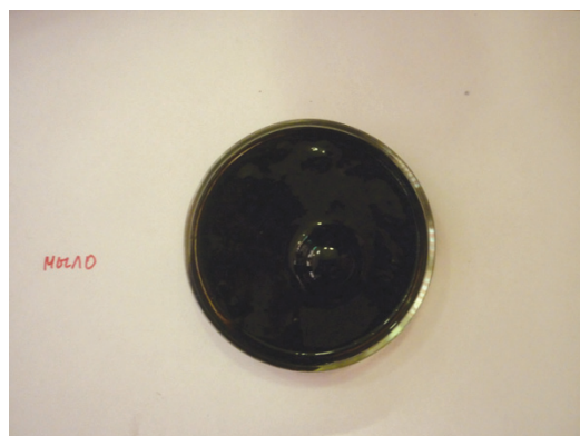
Рис. 11. Взвешенное состояние магнита в магнитной жидкости
