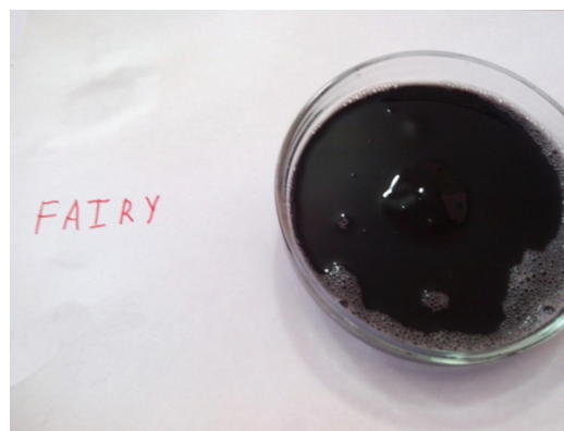
Рис. 10. Получение шипов на поверхности магнитной жидкости
